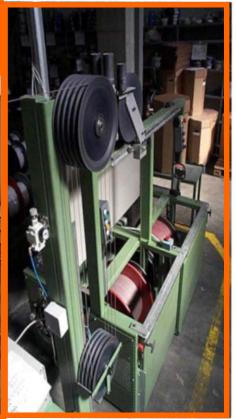
O Geschwindigkeit: 300 mt /min. bei einem Spulenkerndurchmesser von 250 mm.
